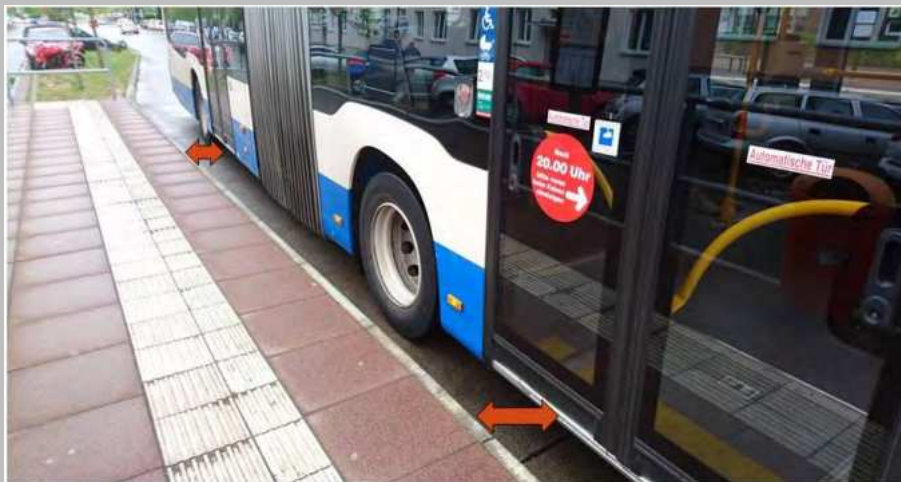
Abbildung 5: Spaltbildung am Einstieg bei nicht optimaler Anfahrbarkeit der Haltestelle
