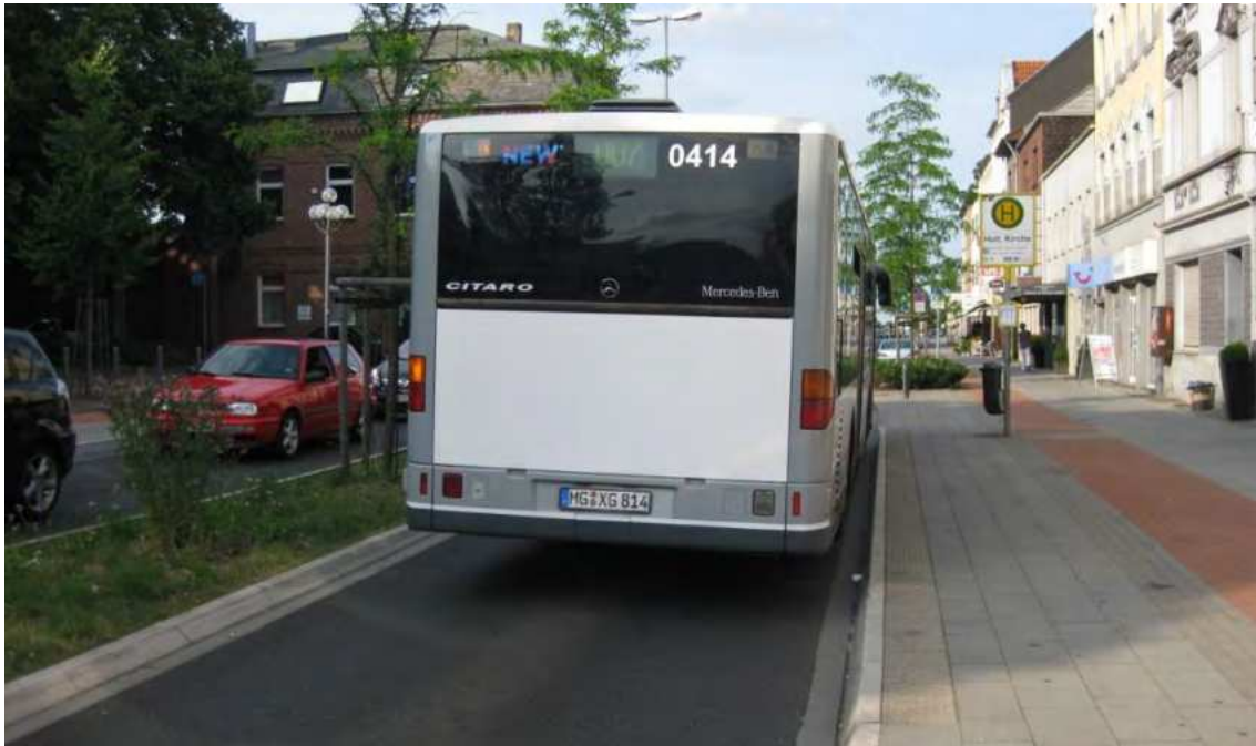
Abbildung 83: Haltestellenkap in Hauptstraße mit Mittelstreifen zur Verhinderung des Überholens (Beispiel: Mönchengladbach)
