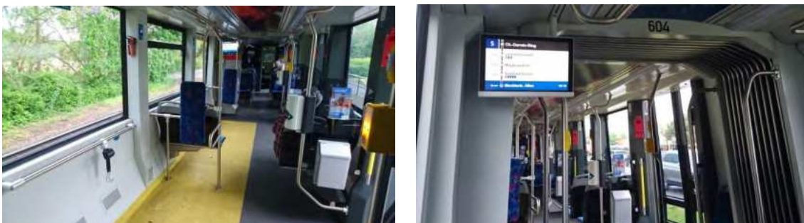
Abbildung 46: Niederflurstraßenbahnen Typ 6N2 (Fahrzeuge entsprechen dem „Stand der Technik“ mit vier Multifunktionsbereichen, Videoüberwachungsanlagen, Haltestellenanzeige sowie Flachbildmonitoren mit Streckenverlaufsanzeige)
